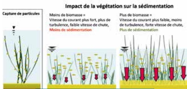
FIGURE 9: SCHEMA DE L'INTERACTION ENTRE LA VÉGÉTATION ET LA SÉDIMENTATION (D'APRÈS FAGHERAZZI ET AL. 2012).
