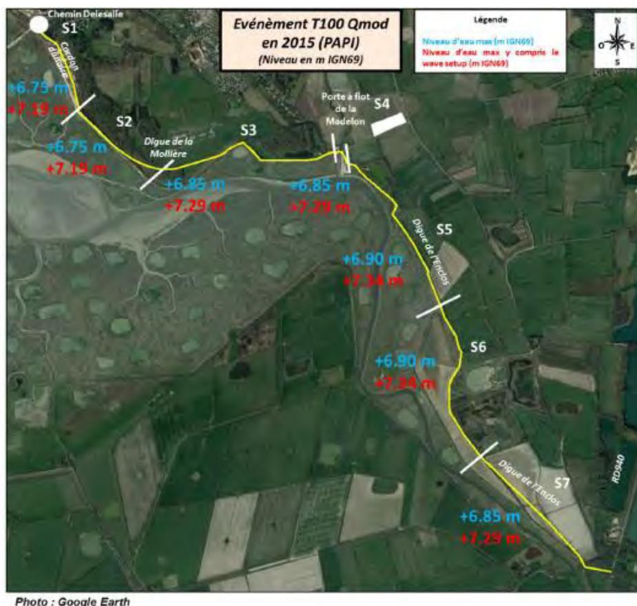
Figure 27 : Niveau d’eau maximal atteint durant la tempête au niveau de la digue de l’Enclos (valeurs bleues issues du modèle 2DH, tenant compte de la marée, du vent et de + 1.20 de surcote ; valeurs rouges : niveaux d’eau tenant compte de la surcote liée aux vagues (valeurs précédentes + wave setup)).
