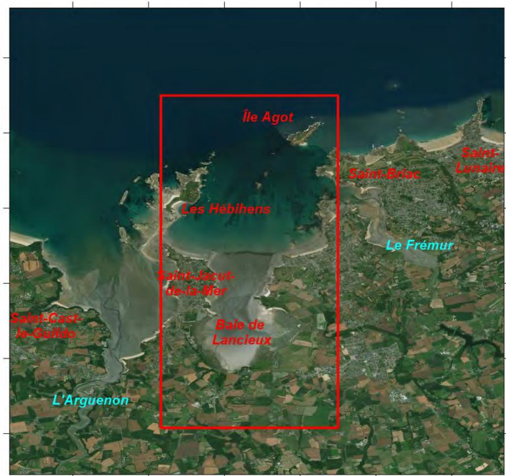
Illustration 51 --- Emprise utilisée pour les simulations numériques de submersion (cadre rouge).
