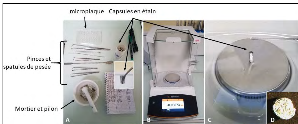
Figure 8 : Matériel utilisé pour le broyage et la pesée des échantillons de tissus végétal (plantes, débris végétaux, macroalgues) et animal (chair de crabes, crevettes et poissons, zooplancton, invertébrés benthiques), A : petit matériel utilisé pour le broyage, la manipulation et le conditionnement des échantillons incluant les capsules en étain destinées aux pesées, B : microbalance Sartorius Quintix 65 utilisée pour les pesées au dixième de mg près, C : capsule pesée sur le plaque de pesée de la microbalance, D : boulette formée après fermeture de la capsule.
