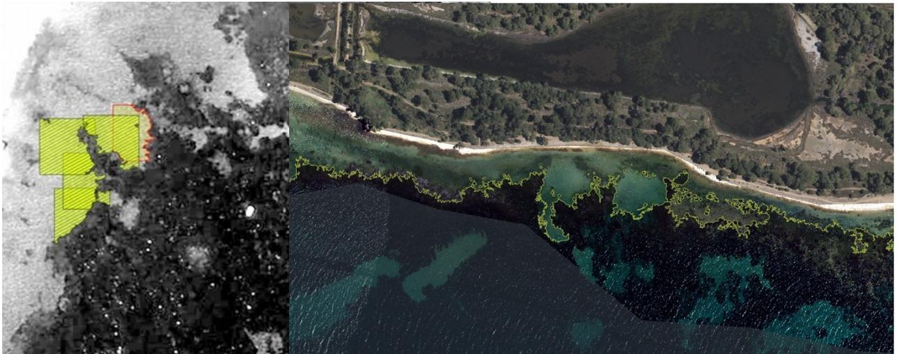
Figure 11 : Principe de la segmentation de l'orthophotographie HR IGN 2017 (Résolution 20 cm)
