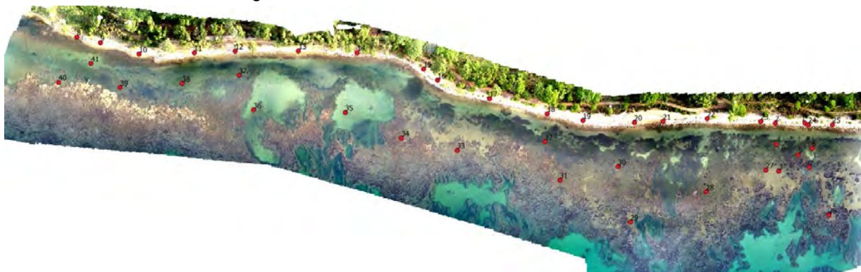
Figure 24 : En rouge : les 41 cibles ont été déposées (en terre et en mer) et enlevées à la fin de la mission.
