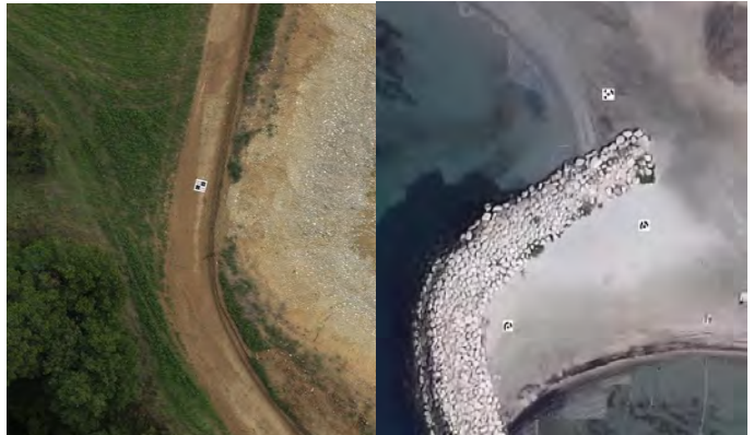
Figure 7 : Exemple d'implantation de cible géo-tagguée
