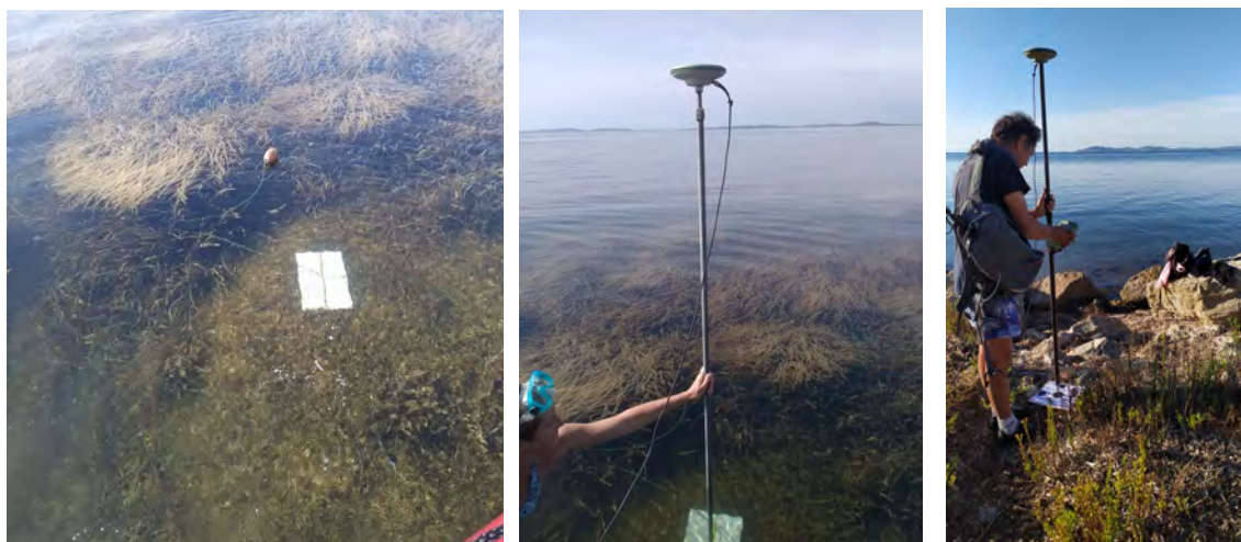
Figure 25 : Mesure au DGPS RTK de la position des cibles en mer et à terre
