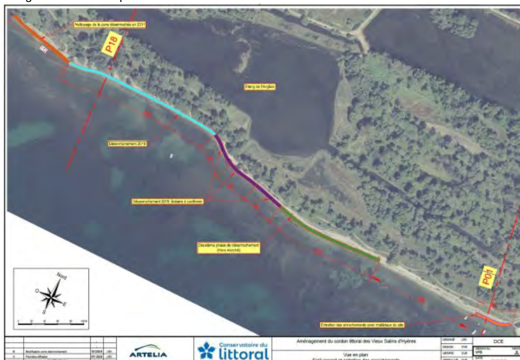
Figure 1 : Zone de travaux (800m) - La cartographie est réalisée au droit des zones de désenrochement futurs, indiquées sur la carte ci-dessus (traits bleu, violet et vert, soit environ 575m), et prolongée sur environ 100m de part et d'autre de cette zone, soit un linéaire total de 800 m
