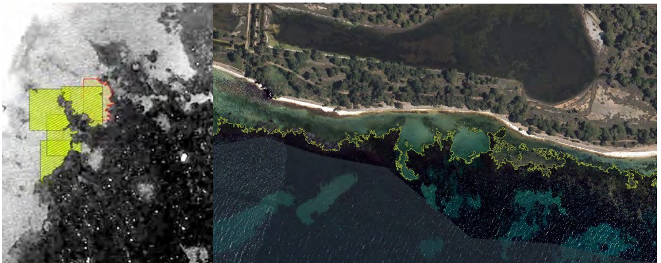
Figure 11 : Principe de la segmentation de l'orthophotographie HR IGN 2017 (Résolution 20 cm)
