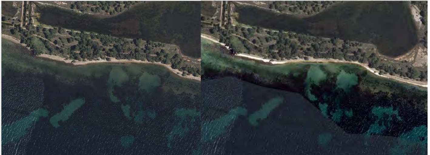
Figure 10 : Exemple d'amélioration de contraste dans la zone de la limite supérieure de l'herbier. A gauche : image BD ORTHO 20cm données brutes - A droite : image BD ORTHO 20cm partiellement traitée.
